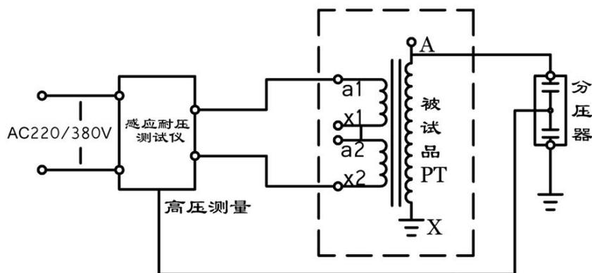
二次绕组串联加压原理图（附图二）
