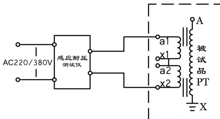
二次绕组串联加压原理图（附图四）
