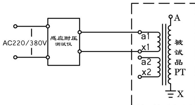
二次绕组加压原理图（附图三）
