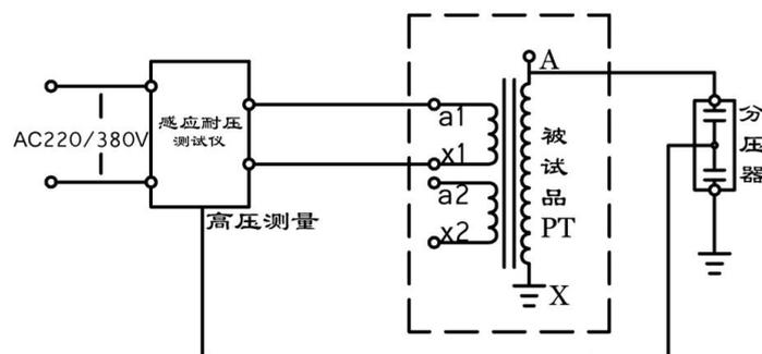
二次绕组加压原理图（附图一）
